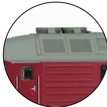
Lüftergitter unterschiedlich, je nach Bauserie
